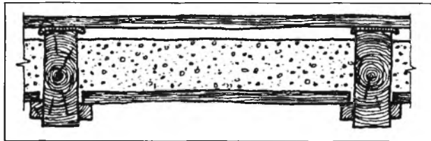
10.6-2 Легкий глинобетон в перекрытии
