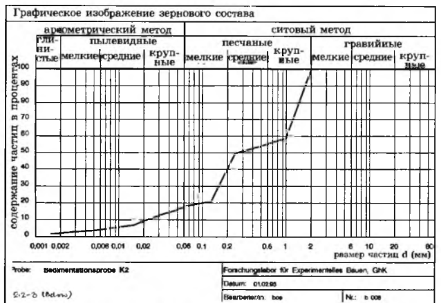
2.2-2 Гранулометрический состав исследуемых грунтов
