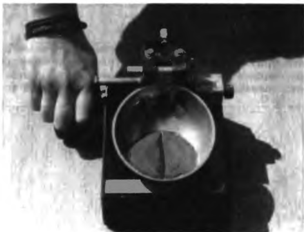
2.3-3 Прибор для определения границы текучести.
