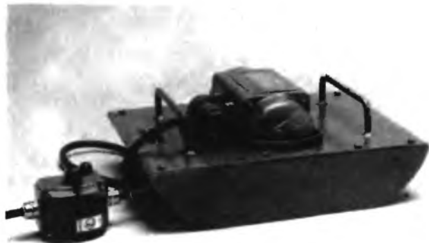
5.3-6 Электрическая виброплита фирмы «Хойзер»
