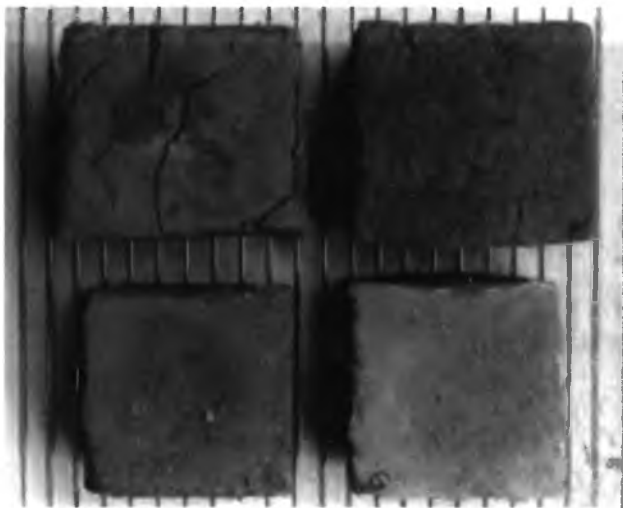
2.3-1 Образцы глинобетона различного состава после испытаний
