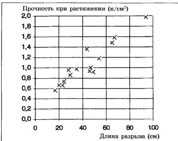
2.2-7 Зависимость прочности от длины разрыва, при растяжении различных типов глинистых грунтов нормальной консистенции по данным ФЕВ
