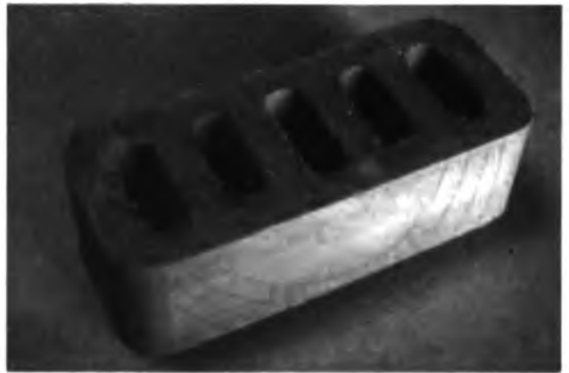
7.5-2 Пустотелый грунтовоый кирпич с закругленными углами
