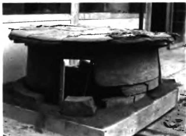
14.13-5—14.13-7 Испытание квадратных и круглых моделей глиносырцовых домов на устойчивость к землетрясениям
