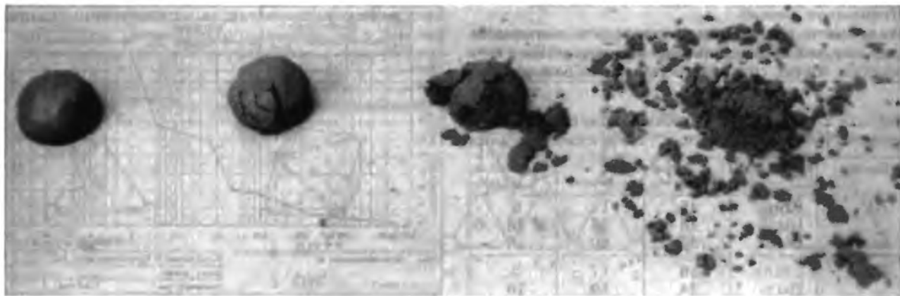
2.2-4 Глиняные шарики после падения с высоты 1,5 м
